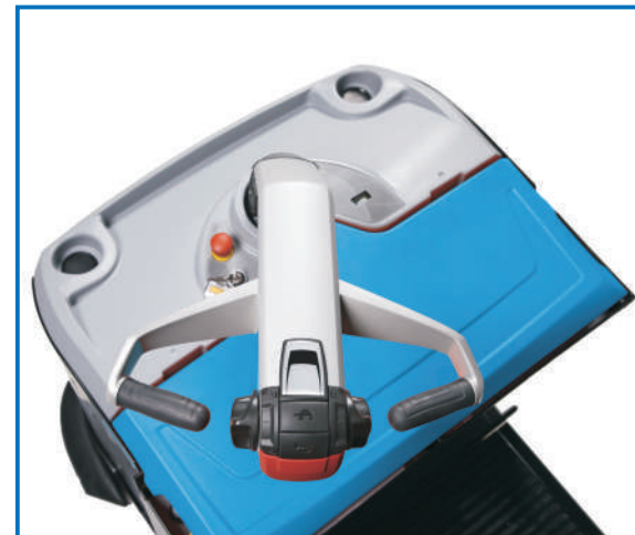
Der patentierte Deichselkopf ist höhenverstellbar und um 170° drehbar.
