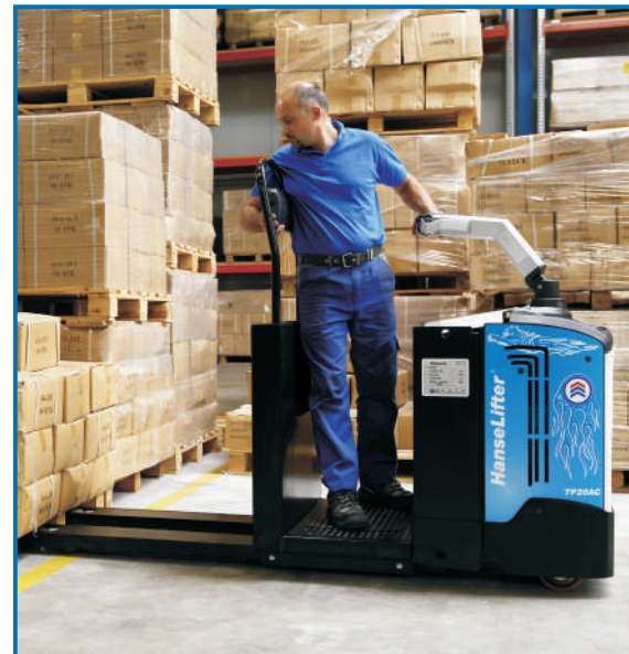
Die praktische Steighilfe ermöglicht das Kommissionieren bis in 2.5m Höhe.
