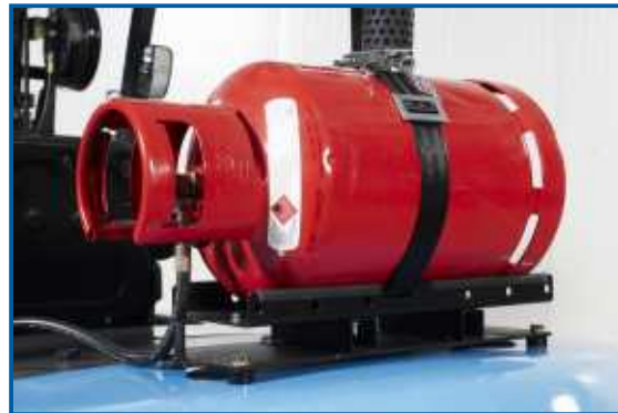
Die Treibgasflasche ist frei zugänglich montiert und lässt sich schnell und einfach, mit wenigen Handgriffen tauschen.
